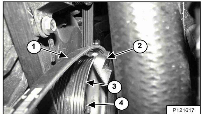
Installez la courroie sur la poulie du compresseur de climatisation et positionnez la courroie (1) et son outil (2) à l'avant de la poulie du vilebrequin (3) [Figure 269].
