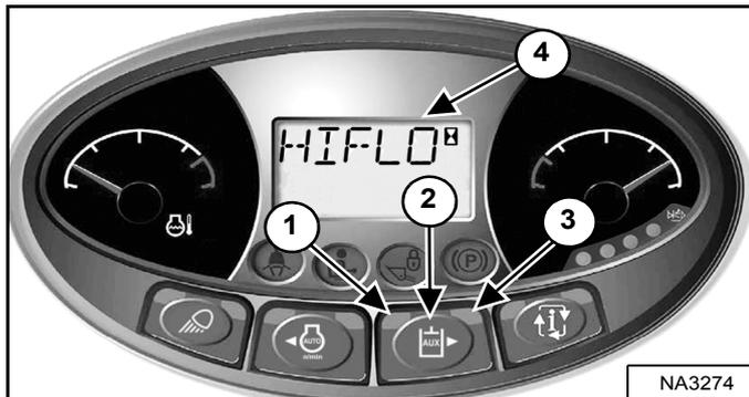
Appuyez une fois sur le bouton du circuit hydraulique auxiliaire (2) pour l'activer. Le témoin (1) **[Figure 93]** s'ALLUME.
