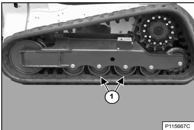
Levez un côté de la chargeuse et placez des chandelles sous les coins avant et arrière du châssis de façon à ce que la chenille soit décollée du sol d'environ 76 mm (3") [Figure 252]. Abaissez la chargeuse sur les chandelles. Évitez tout contact entre les chandelles et la chenille.
