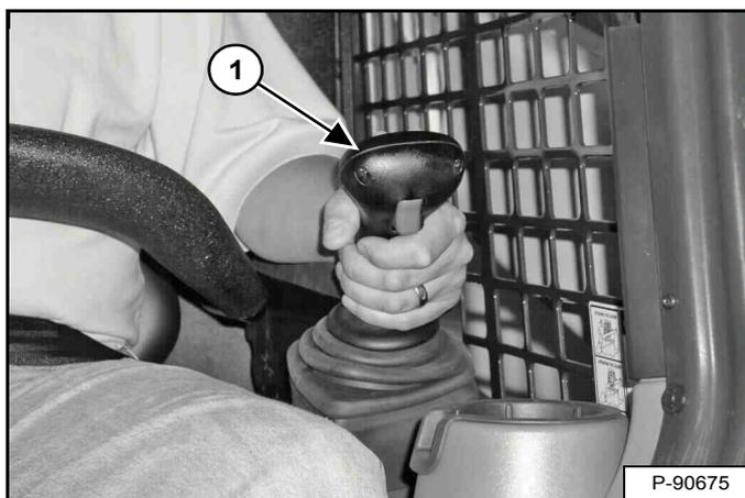
Le manipulateur qui commande la translation et la direction se trouve à gauche à l'avant du siège (1) [Figure 56].
