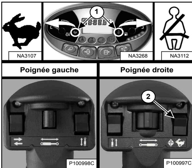
Appuyez sur le haut du contacteur (2) de la poignée droite pour passer en grande vitesse. Les icônes de la commande deux vitesses et de la sangle d'épaule du tableau de bord gauche (1) [Figure 62] s'allument.
