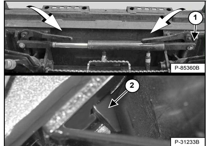
Appuyez sur le côté DOWN du contacteur BOB-TACH WEDGES (broches coniques vers le bas) (panneau des contacteurs droit) et maintenez-le enfoncé [Figure 146] jusqu'à ce que les leviers soient complètement engagés en position verrouillée [Figure 147] (les broches coniques dépassent des orifices du châssis de fixation de l'accessoire).
