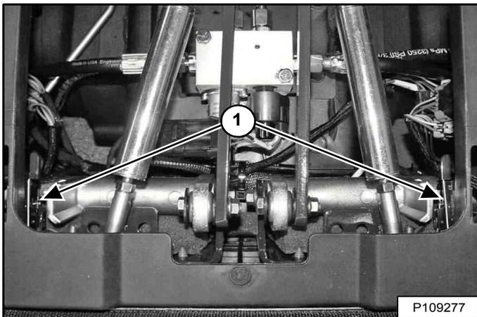
Les contacteurs de l'alarme de recul (1) [Figure 176] sont situés contre les leviers de direction. Les deux contacteurs doivent être correctement réglés pour que l'alarme de recul fonctionne convenablement.
