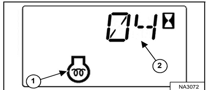
Si la température est basse, les bougies de préchauffage s'allument automatiquement. L'icône du préchauffage du moteur (1) s'allume et le temps de préchauffage (2) [Figure 125] est décompté sur l'affichage des données.
