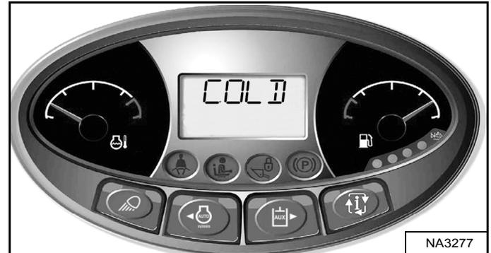
Le contrôleur du moteur limite la vitesse et le couple du moteur lorsque sa température est trop basse. Le contrôleur du moteur génère alors automatiquement les indications et les actions suivantes :
