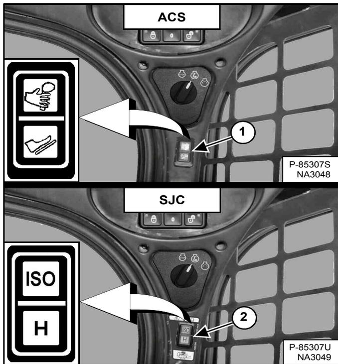
(ACS) Sélectionnez le fonctionnement par commandes manuelles ou par pédales (1) [Figure 121] si la machine est équipée de commandes ACS.
