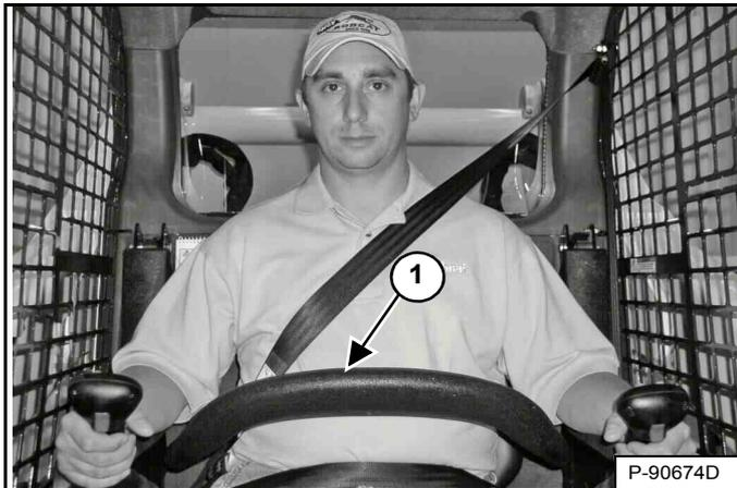
Le dispositif de sécurité de l'arceau de siège comprend un arceau de siège pivotant avec accoudoirs (1) [Figure 165].
