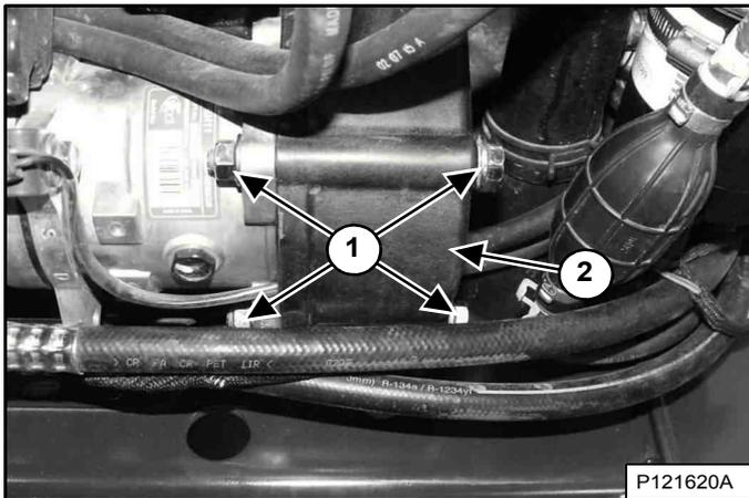
Déposez les écrous et boulons de fixation (1) du capot de la courroie de la climatisation et déposez le capot de la climatisation (2) [Figure 267].
