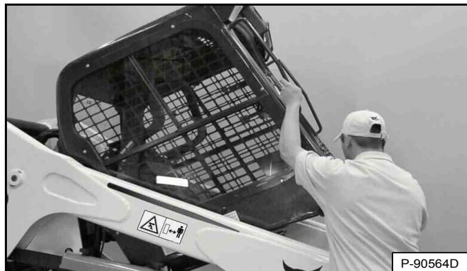
Levez lentement la cabine de l'opérateur par les mains courantes et le bas de la cabine [Figure 182] jusqu'à ce qu'elle soit complètement levée et que son mécanisme de verrouillage s'enclenche.
