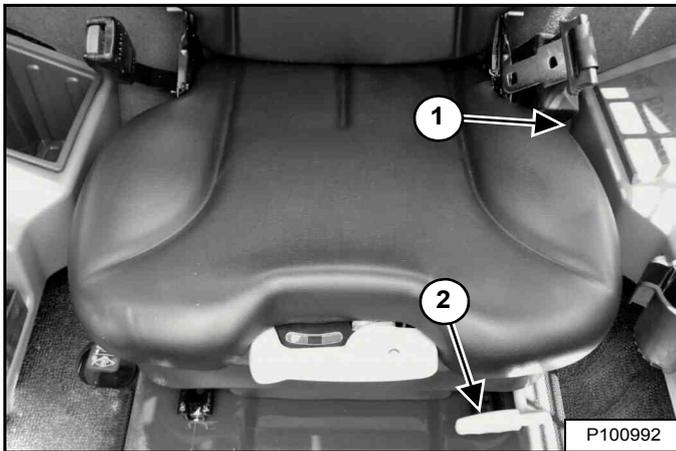
Levez le levier (1) [Figure 105] pour ajuster l'inclinaison du dossier du siège.
