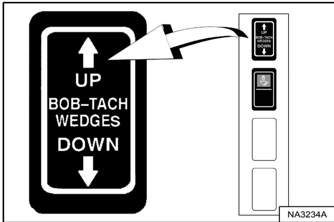
Appuyez sur le côté UP du contacteur BOB-TACH WEDGES (broches coniques vers le haut) (panneau des contacteurs droit) et maintenez-le enfoncé.
