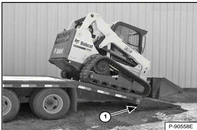
Faites monter la chargeuse en marche arrière sur le véhicule de transport si le godet est vide, ou si l'accessoire a été déposé [Figure 162].
