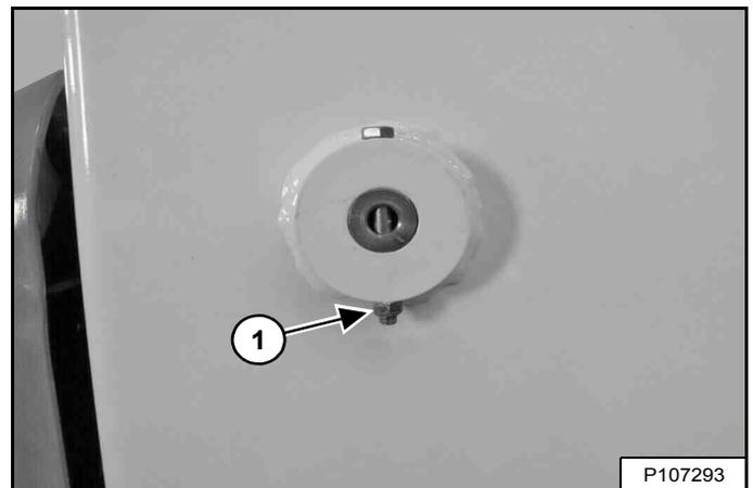
Tous les points pivots des vérins et des bras de levage possèdent un grand axe maintenu en place à l'aide d'un boulon de retenue et d'un écrou freiné (1) [Figure 291].
