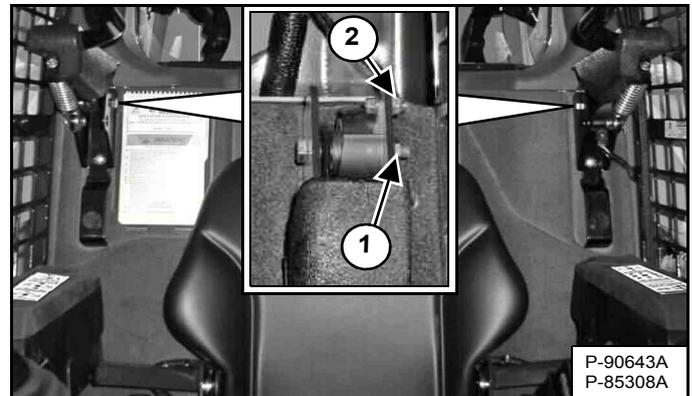
Éliminez les débris ou les saletés des points pivots à l'air comprimé. Ne lubrifiez pas. Contrôlez la visserie de fixation. Le couple de serrage correct de l'écrou d'articulation (des deux côtés) (1) est de 34 à 38 Nm (25 à 28 ft.-lb.). Le couple de l'écrou du capteur de l'arceau de siège (côté gauche uniquement) (2) [Figure 166] est de 6 à 8 Nm (50 à 70 in.-lb.).
