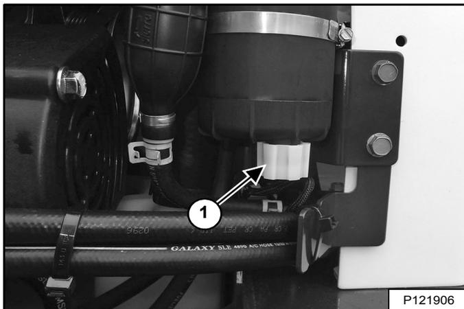
Desserrez le purgeur (1) [Figure 206] situé au bas du filtre pour vidanger l'eau emprisonnée dans le filtre.
