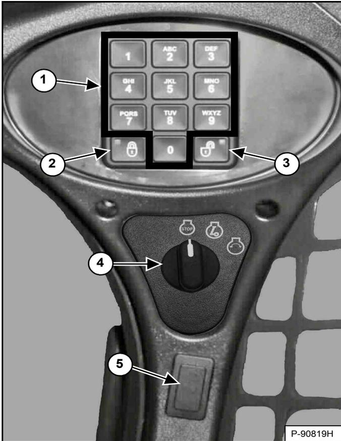
Cette machine peut être équipée d'un tableau à démarrage sans clé [Figure 14].
