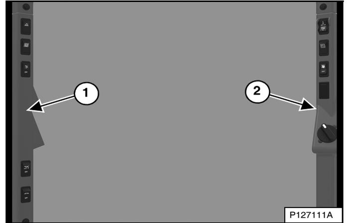
Les panneaux de contacteurs gauche (1) et droit (2) [Figure 9] sont décrits plus en détail. (voir Tableau des contacteurs gauche, page 45) et (voir Tableau des contacteurs droit, page 45)
