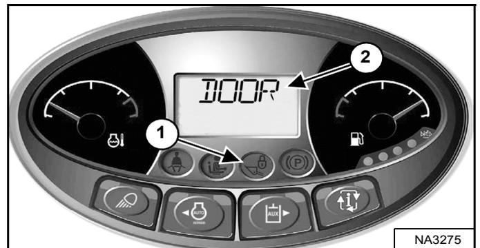
Le témoin de LEVAGE ET CAVAGE (1) [Figure 179] s'ÉTEINT lorsque la porte est fermée, que le contacteur à clé est mis en position MARCHÉ, que l'arceau de siège est abaissé et que le bouton PRESS TO OPERATE LOADER (APPUYER POUR UTILISER LA CHARGEUSE) est enfoncé.
