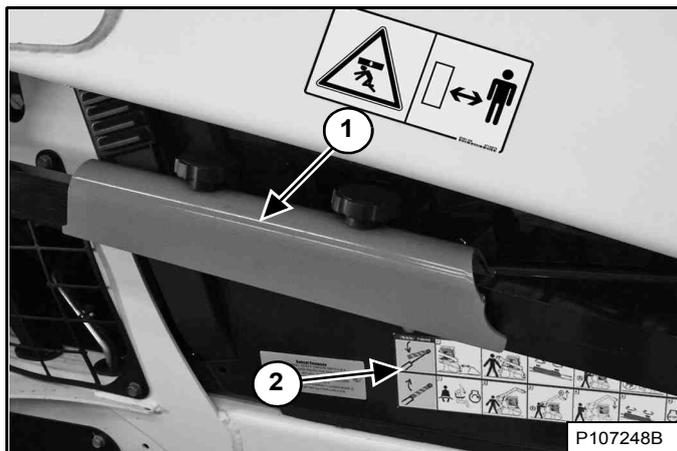
L'arrêt de bras de levage (1) [Figure 168] sert à maintenir les bras de levage pour travailler sur une machine dont les bras sont relevés.
