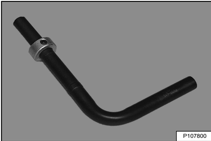
Un outil purgeur **[Figure 251]** est disponible et recommandé pour réduire la tension des chenilles. L'outil purgeur oriente l'écoulement de la graisse pour faciliter le nettoyage. Consultez votre concessionnaire Bobcat pour commander un outil purgeur.
