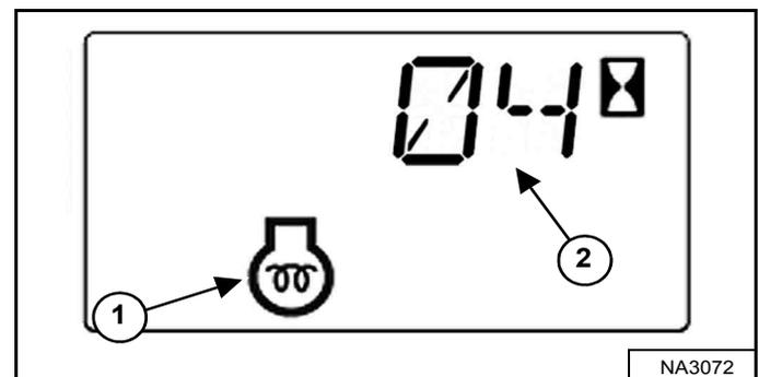
Si la température est basse, les bougies de préchauffage s'allument automatiquement. L'icône du préchauffage du moteur (1) s'allume et le temps de préchauffage (2) [Figure 115] est décompté sur l'affichage des données.
