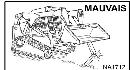
**!** Ne travaillez jamais sur la chargeuse avec les bras de levage relevés, à moins qu'ils ne soient maintenus par un arrêt de bras de levage approuvé.
