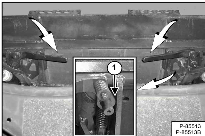
Abaissez les leviers du Bob-Tach jusqu'à ce qu'ils soient complètement verrouillés [Figure 137] (les broches coniques dépassent des orifices du châssis de fixation de l'accessoire).
