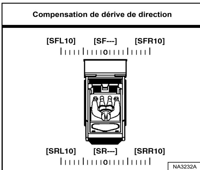
La compensation de dérive de direction comprend au total 21 réglages. La compensation de dérive de direction peut être réglée sur n'importe quel point entre le point NEUTRE et **[SFL10]** ou **[SRL10]** sur la gauche, et entre le point NEUTRE et **[SFR10]** ou **[SRR10]** sur la droite. **[SF---]** ou **[SR---]** s'affiche lorsque le réglage est sur le point neutre **[Figure 69]**.
