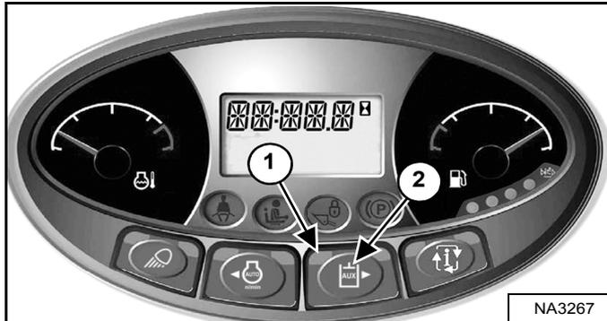
Appuyez une fois sur le bouton du circuit hydraulique auxiliaire (2) [Figure 84] pour l'activer.
