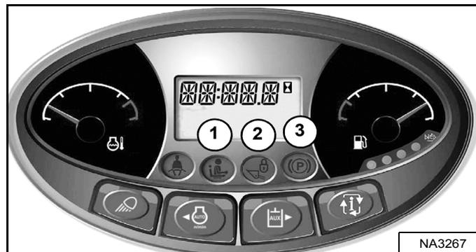
Les trois témoins (1, 2 et 3) [Figure 31] du tableau de bord gauche doivent être ÉTEINTS pour pouvoir utiliser la machine avec toutes ses fonctions.
