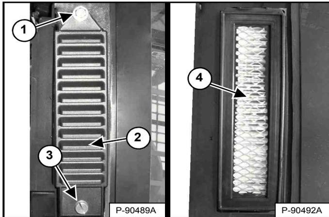
Les filtres d'air frais se trouvent derrière les vitres latérales, à l'extérieur de la cabine (côté droit représenté). Déposez la vis de blocage (3) et le couvercle du filtre (2) [Figure 190] (les bras de levage sont représentés levés pour plus de clarté).
