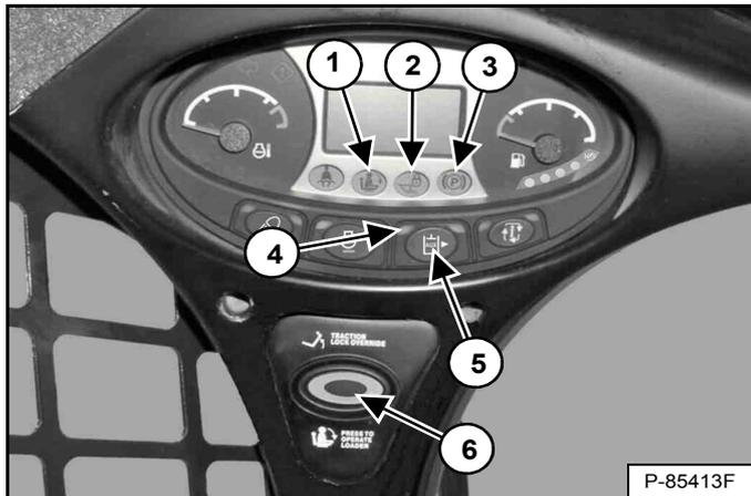
1. Installez-vous dans le siège de l'opérateur. Tournez le contacteur à clé sur la position MARCHE. Abaissez l'arceau de siège et libérez le frein de stationnement. Appuyez sur le bouton PRESS TO OPERATE LOADER (APPUYER POUR UTILISER LA CHARGEUSE) (6). Les deux témoins BICS™ (1 et 2) [Figure 164] [ARCEAU DE SIÈGE et LEVAGE ET CAVAGE] du tableau de bord gauche doivent être ALLUMÉS. Le bouton PRESS TO OPERATE LOADER (APPUYER POUR UTILISER LA CHARGEUSE) s'allume.
