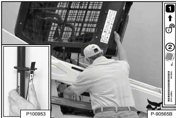
Tirez vers le bas la partie inférieure de la cabine jusqu'à ce qu'elle se cale sur le mécanisme de verrouillage [Figure 183].
