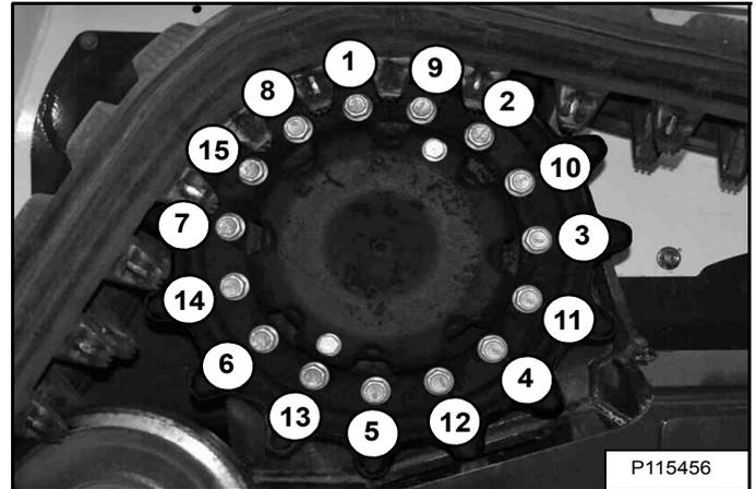
Vérifiez le couple des quinze boulons de barbotins de la chenille (1 - 15) [Figure 262]. Utilisez une séquence de serrage alternative et répétez-la pour serrer les boulons au couple de 127 à 138 N (94 à 102 ft-lb).
