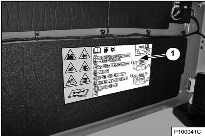
Le tableau d'entretien et la liste de contrôle (1) [Figure 102] sont situés dans la porte arrière de la chargeuse.
