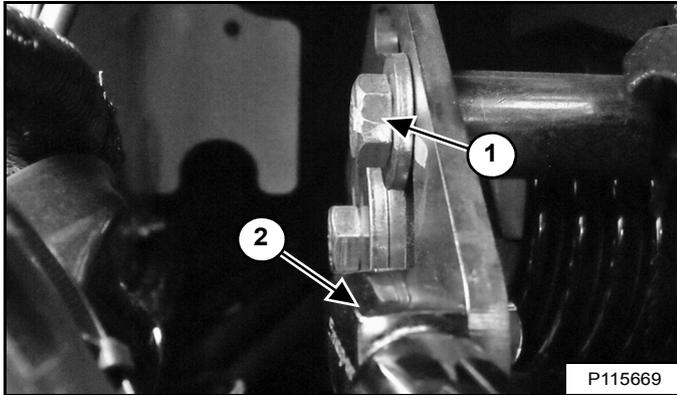
Réglez une clé dynamométrique sur un couple de 54,2 Nm (40 ft.-lb.). Insérez la clé dynamométrique (2) [Figure 276] dans la fente prévue à cet effet dans le bras d'arrêt, comme indiqué, et relevez-la jusqu'à ce que le couple adéquat soit indiqué.
