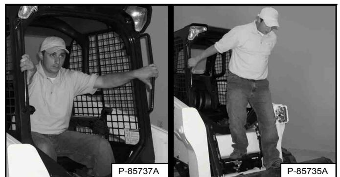
Sortez de la chargeuse en utilisant les mains courantes, les antidérapants et les marchepieds (en maintenant un contact en trois points) [Figure 132].
