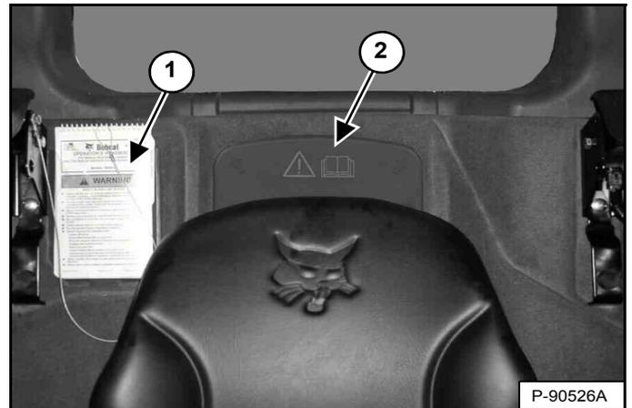
Lisez et comprenez le contenu du Manuel de l'Opérateur et d'Entretien et du Guide de l'Opérateur (1) [Figure 104] avant d'utiliser la chargeuse.
