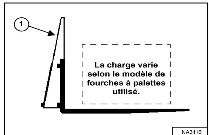
La charge maximale pouvant être déplacée à l'aide de fourches à palettes est indiquée sur un autocollant situé sur le châssis des fourches (1) [Figure 134].
