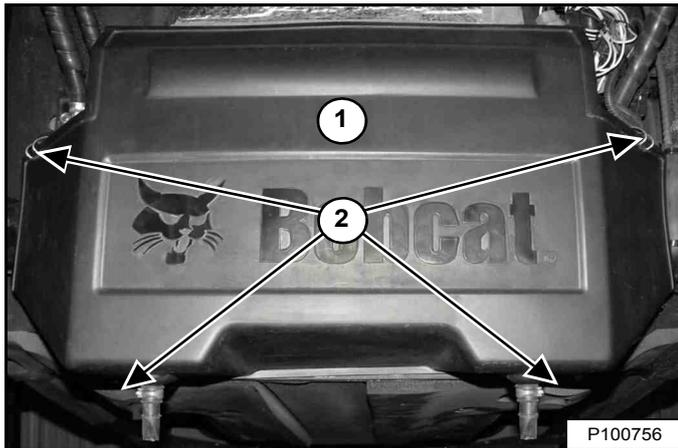
Ouvrez les attaches (2) et déposez le couvercle (1) [Figure 192].
