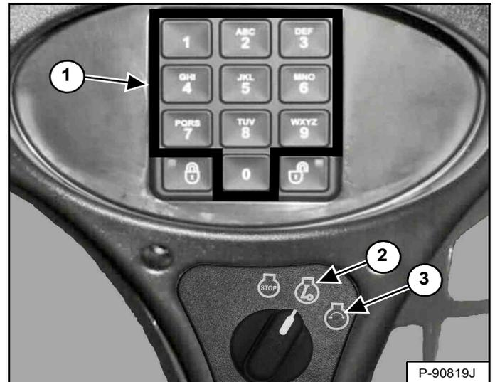
Tournez le contacteur à clé sur la position MARCHÉ (2). Les témoins du tableau de bord gauche s'ALLUMENT brièvement tandis que le tableau de bord/système de surveillance exécute un test automatique. Utilisez le pavé numérique (1) [Figure 119] pour saisir le mot de passe.
