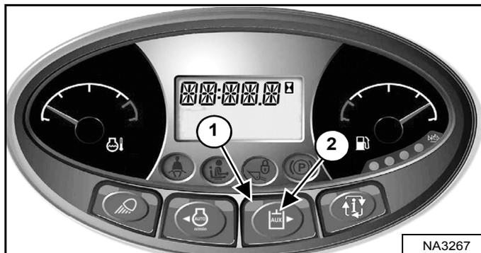
Appuyez une fois sur le bouton du circuit hydraulique auxiliaire (2) [Figure 89] pour l'activer.
