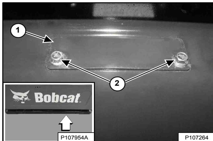
Le flexible de vidange d'huile est situé derrière un capot (1) sous l'arrière de la chargeuse (médaillon) [Figure 211].
