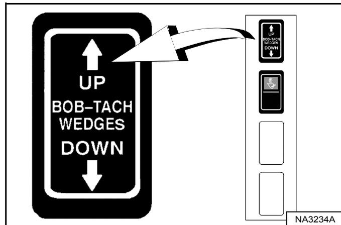
Appuyez sur le côté UP du contacteur BOB-TACH WEDGES (broches coniques vers le haut) (panneau de contacteurs droit) et maintenez-le enfoncé [Figure 148] jusqu'à ce que les leviers soient complètement engagés (broches coniques complètement relevées).
