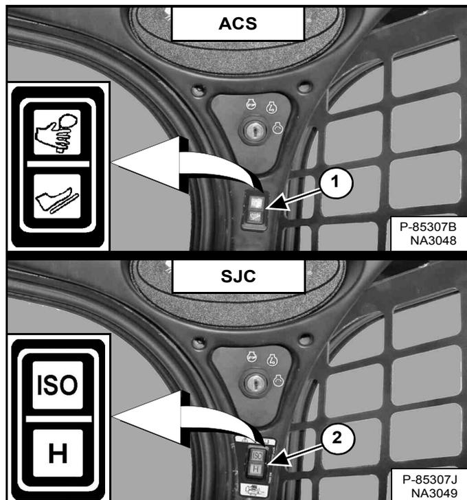
(ACS) Sélectionnez le fonctionnement par commandes manuelles ou par pédales (1) [Figure 116] si la machine est équipée de commandes ACS.
