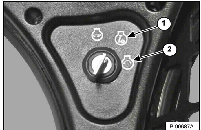
Tournez le contacteur à clé sur la position MARCHÉ [Figure 114]. Les témoins du tableau de bord gauche s'ALLUMENT brièvement tandis que le tableau de bord/système de surveillance exécute un test automatique.
