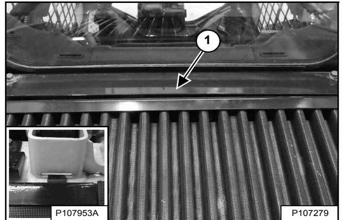
Alignez le bord de la grille arrière sous le capot (1), insérez les ergots dans les encoches (côté droit illustré) (voir médaillon) **[Figure 189]** et abaissez.
