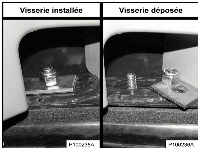
Déposez les écrous et les rondelles [Figure 181] (des deux côtés) aux coins avant de la cabine.
