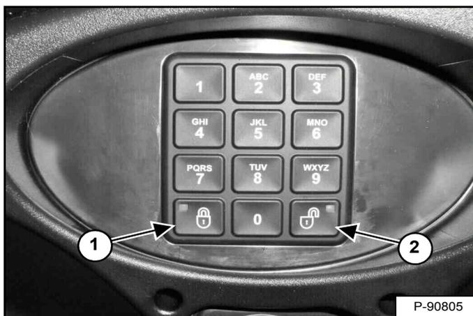
Enfoncez et maintenez les boutons de verrouillage (1) et de déverrouillage (2) [Figure 301] pendant 2 secondes.
