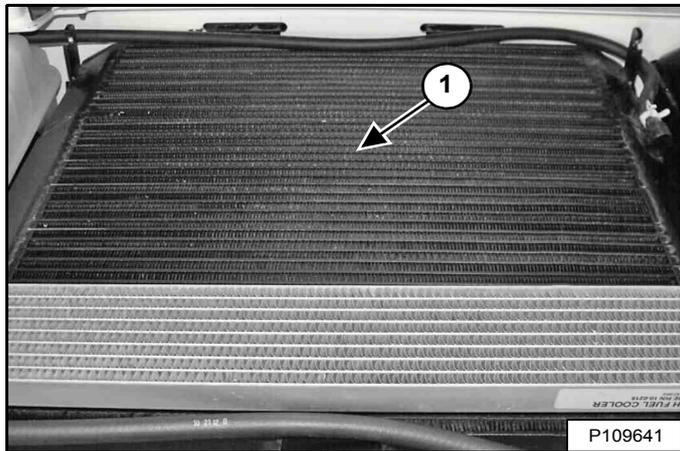
Nettoyez le dessus de l'ensemble refroidisseur d'huile hydraulique et radiateur avec de l'air ou de l'eau à basse pression (1) [Figure 220].
