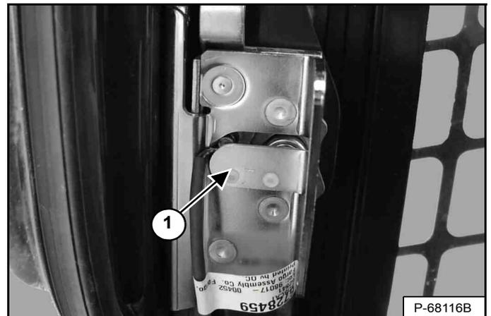
La porte de cabine est équipée d'un capteur (1) [Figure 178] qui désactive les fonctions de levage et de cavage lorsque la porte est ouverte.
