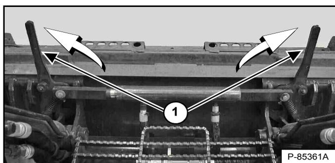
Appuyez sur le côté UP du contacteur BOB-TACH WEDGES (broches coniques vers le haut) (panneau des contacteurs droit) et maintenez-le enfoncé [Figure 141] jusqu'à ce que les leviers (1) [Figure 142] soient complètement engagés (broches coniques complètement relevées).
