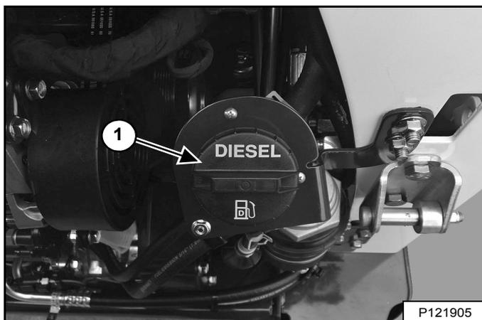
Retirer le bouchon du réservoir de carburant (1) [Figure 204].
