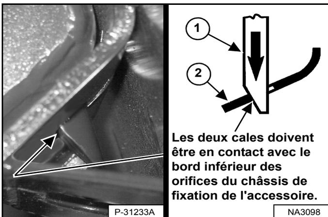
Les broches coniques (1) [Figure 293] doivent dépasser des orifices du châssis de fixation de l'accessoire.
