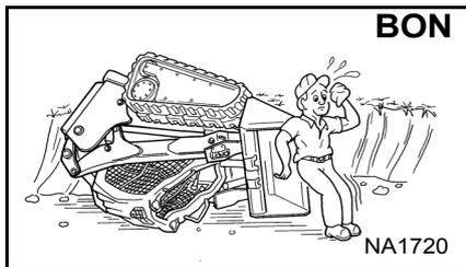
**N'utilisez jamais la chargeuse sans la cabine de sécurité approuvée ROPS et FOPS.** Attachez la ceinture de sécurité.
