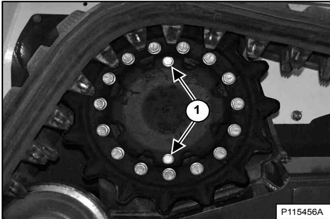
Stationnez la chargeuse de sorte que les bouchons (1) [Figure 261] du moteur d'entraînement hydrostatique se trouvent en bas et en haut.
