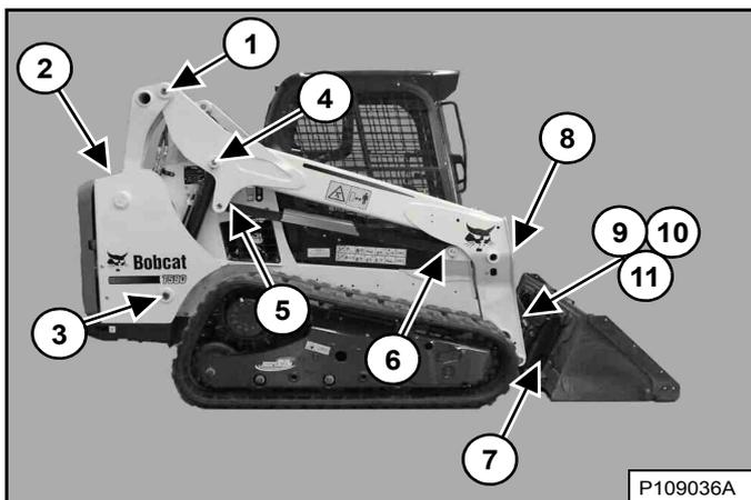
Les emplacements des graisseurs [Figure 279] sont indiqués plus en détail dans les figures suivantes.
