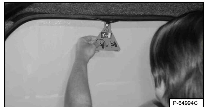
Tirez sur l'étiquette en haut de la vitre arrière pour retirer le cordon en caoutchouc [Figure 42].
