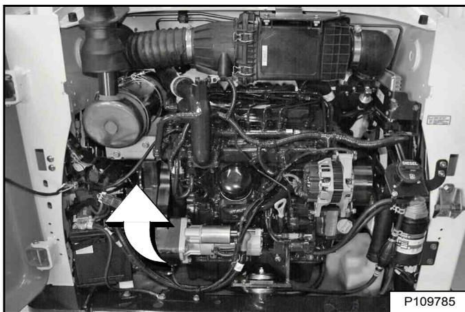
L'arrêt du tendeur à ressort est situé au-dessus de la batterie, du côté gauche du moteur [Figure 270].
