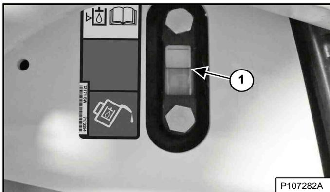
Contrôlez le niveau d'huile dans la jauge transparente (1) [Figure 239]. Maintenez le niveau d'huile entre les repères supérieur et inférieur.
