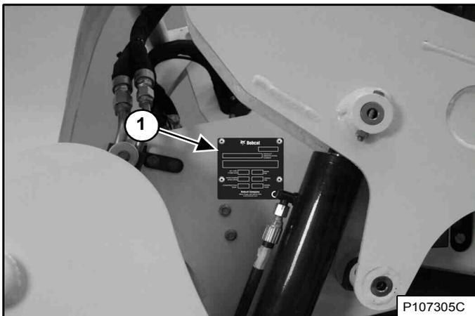
Le numéro de série de la chargeuse (1) [Figure 1] est apposé à l'extérieur du châssis.
