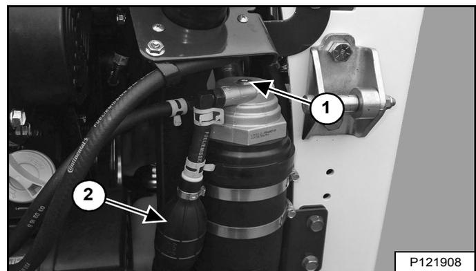
Ouvrez le purgeur d'air (1) [Figure 208] situé sur l'ensemble du filtre à carburant de trois tours.
