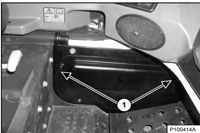
Le boîtier de fusibles et de relais se trouve derrière un panneau d'accès situé près de la pédale ou du repose-pied gauche. Saisissez le panneau par ses extrémités (1) et tirez [Figure 229] pour le déposer.
