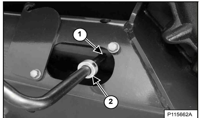
Installez l'outil purgeur (7277225) sur le raccord de tension des chenilles (1), réglez et serrez le collier (2) [Figure 259] de sorte qu'il se place derrière le bord du capot d'accès.
