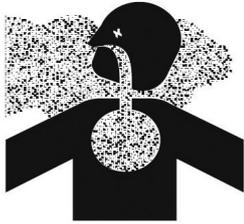
La découpe ou le perçage de béton contenant du sable ou de roche contenant du quartz peut vous exposer à de la poussière de silice. Utilisez un masque, de l'eau pulvérisée ou tout autre moyen pour vous protéger de la poussière.
